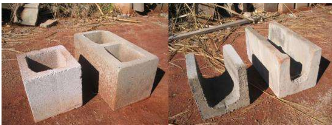
Figura 89 – Blocos de concreto utilizados na obra. Respectivamente, bloco comum e canaleta.
