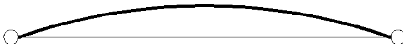
Figura 63 – Situação de flambagem de arco fora do seu plano (vista em planta).
