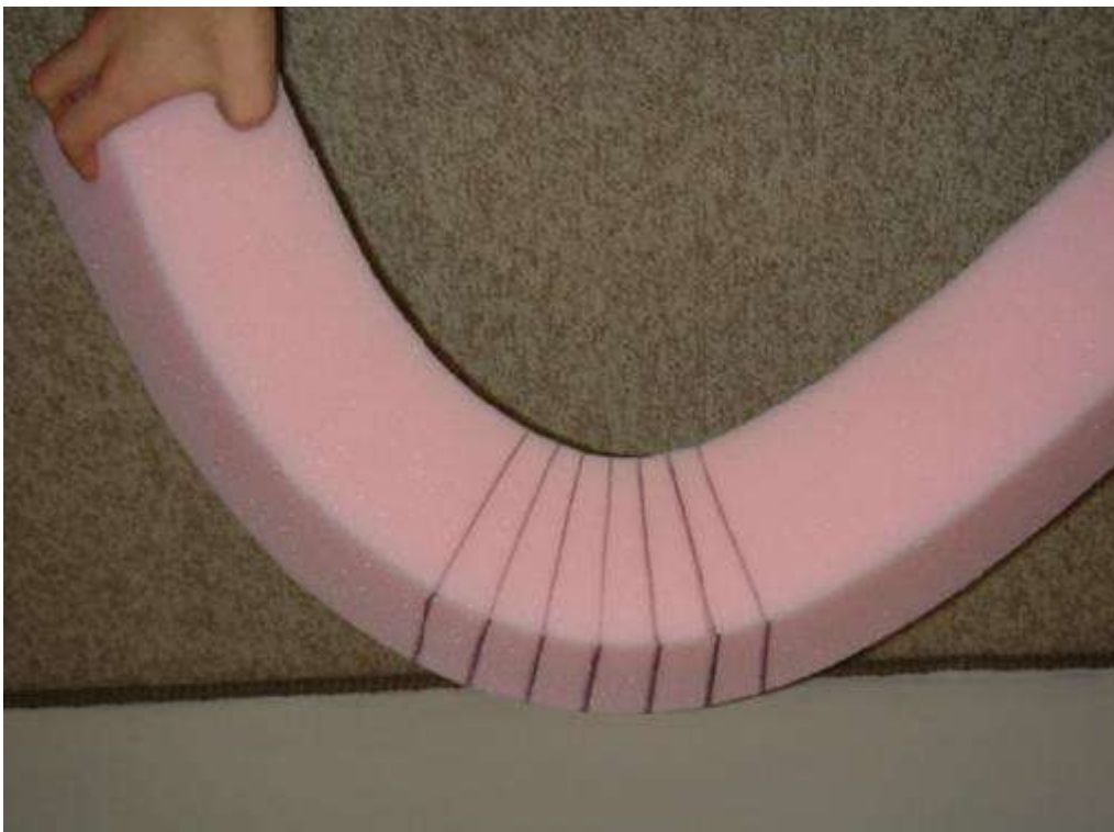
Figura 16 – Modelo que esquematiza a deformação de uma viga submetida à flexão pura.
